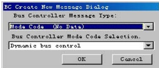
消息类型和模式代码的具体含义请参考1553标准。当用户选择好后，执行OK就可以了，用户会发现刚才的窗口中的命令字区会有明显的变动。这时，用户就可以再手动地对该消息进行编辑了。也就是说先确定消息的类型，再对该类型的消息进行具体项的配置。
